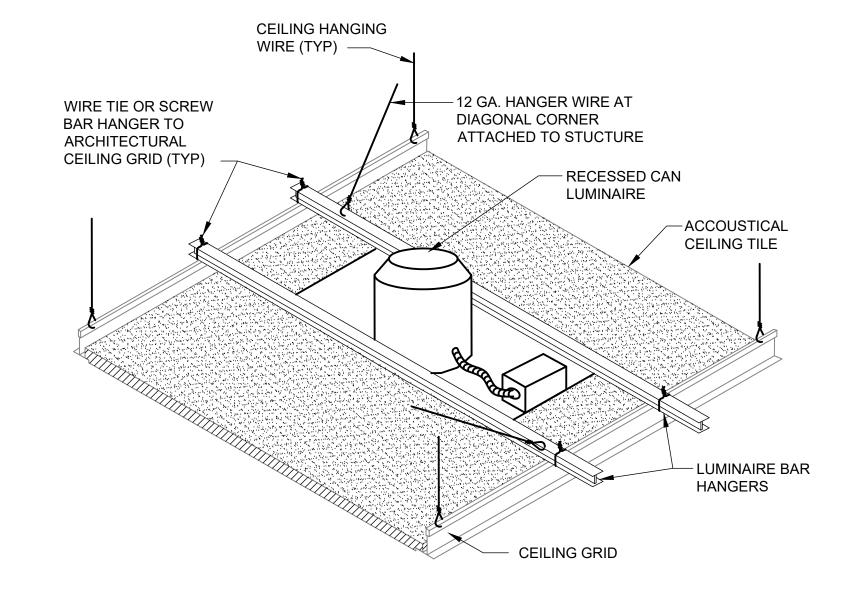
DOWNLIGHT MOUNTING - LAY-IN-CEILING NO SCALE
